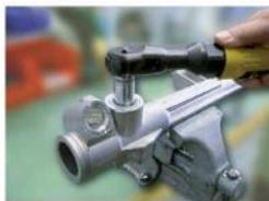
При сборке и затягивании резьбового соединения микрокапсулы в слое покрытия разрушаются. Жидкие компоненты высвобождаются, полностью заполняют пространство в резьбовой паре и быстро затвердевают, образуя единую систему, которая обеспечивает надежную герметизацию и максимальную устойчивость к динамическим и термическим нагрузкам.
