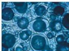
Покрытие Precote® 85, изготавливается на основе толуола и двухкомпонентной структуры, состоящей из акрилата и отвердителя, которые окружены микрокапсулой полимерной пленкой.
