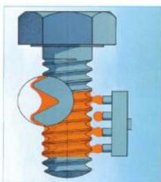
После нанесения Precote® 85 на резьбовое изделие и процесса сушки происходит образование сухого и твердого покрытия, которое остается неактивным вплоть до сборки резьбового соединения.
